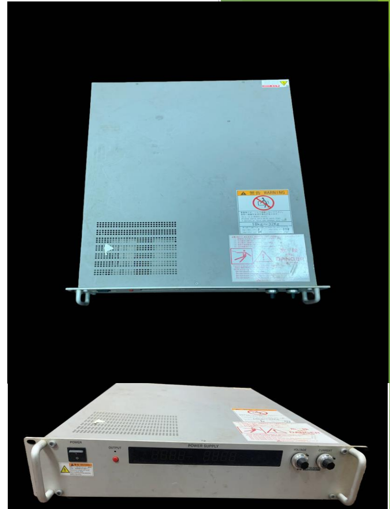
高壓電源供應器一台 MATSUSADA AU-100
